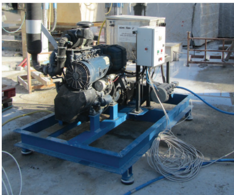
Unità alta pressione, completamente autonoma, con motorizzazione diesel.
