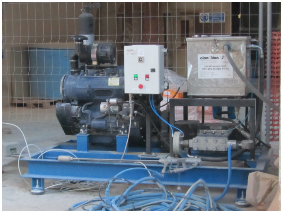
Unità alta pressione in contesto applicativo per preparazione superfici e idrodemolizione
