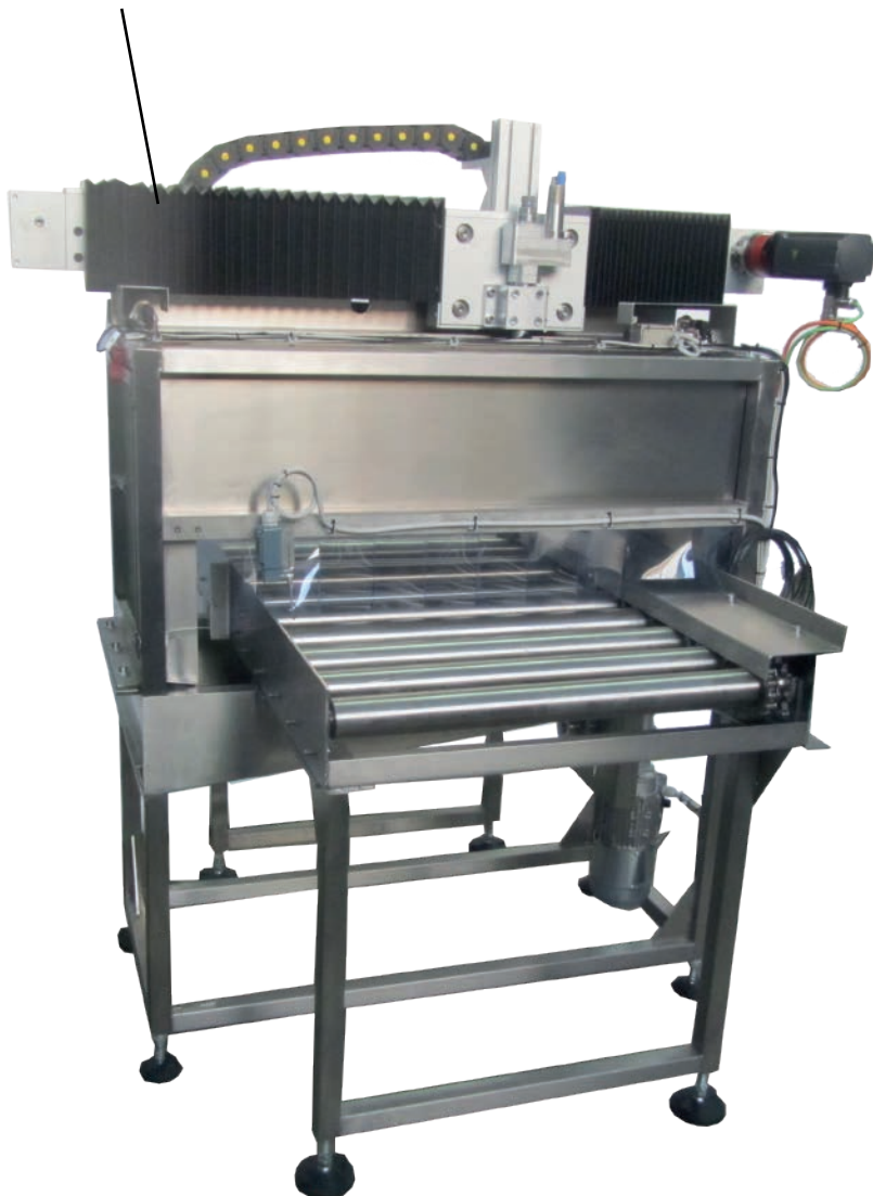
Esempio di modulo automatizzato di pulizia e rimozione coating con guida lineare
